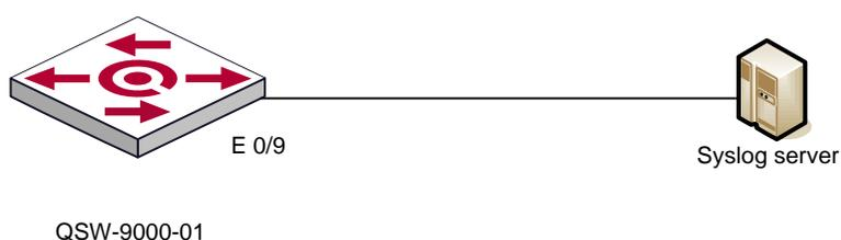
Исходное состояние: К коммутатору Ethernet подключаются хосты. На данных хостах устанавливается Syslog сервер. IP-адреса для указанных хостов конфигурируются вручную и должны находиться в пределах той же подсети, что и IP-адрес коммутатора. На коммутаторе конфигурируется регистрация событий на данных Syslog серверах.
