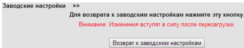
Окно Заводские настройки содержит кнопку «Возврат к заводским настройкам», при нажатии на которую будут сброшены все текущие настройки телефона, и будет осуществлён переход к заводским настройкам.
