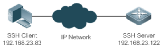
Рисунок 38. Сетевая топология передачи файлов SSH
