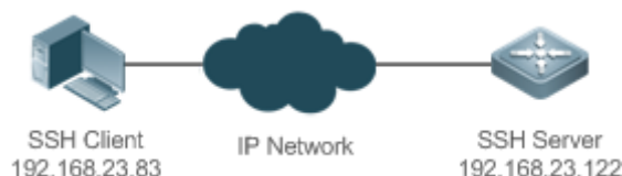
Рисунок 34. Сетевая топология управления устройствами SSH
