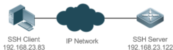
Рисунок 37. Топология сети для аутентификации пользователей SSH с помощью открытого ключа
