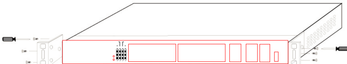
Рисунок 3-1 Монтаж кронштейнов на коммутатор
