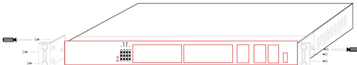
Рисунок 3-1 Монтаж кронштейнов на коммутатор
