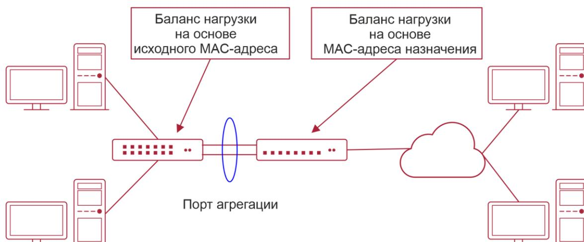
Рисунок 4-1. Агрегация каналов AP и балансировка нагрузки
