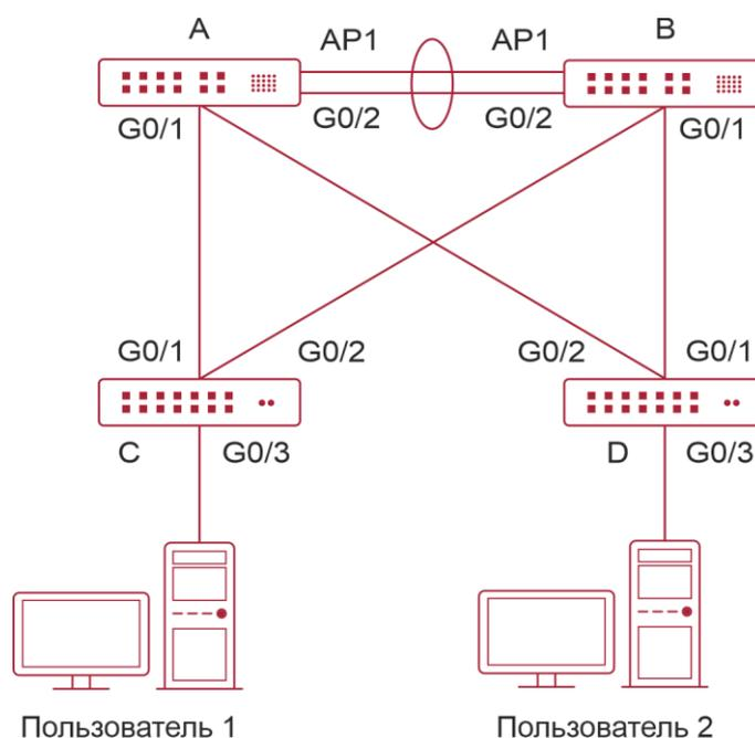
Рисунок 10-1. Dual-Core топология MSTP+VRRP
