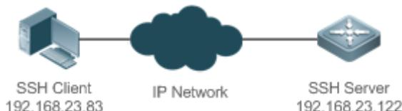
Рисунок 7-1. Сетевая топология управления устройствами SSH
