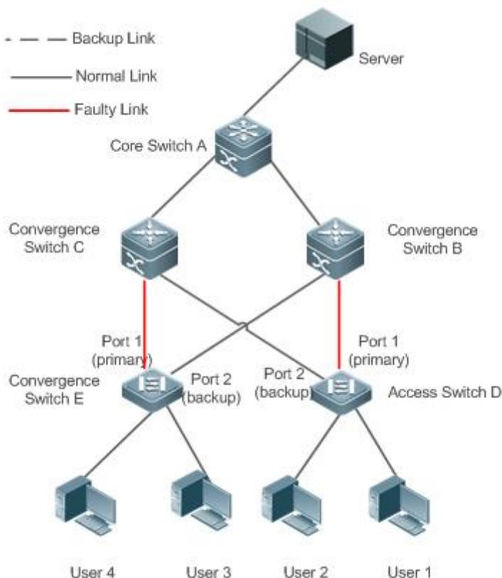
Рисунок 1-3. Топология с интерфейсом 1 коммутатора D (E) неисправна
