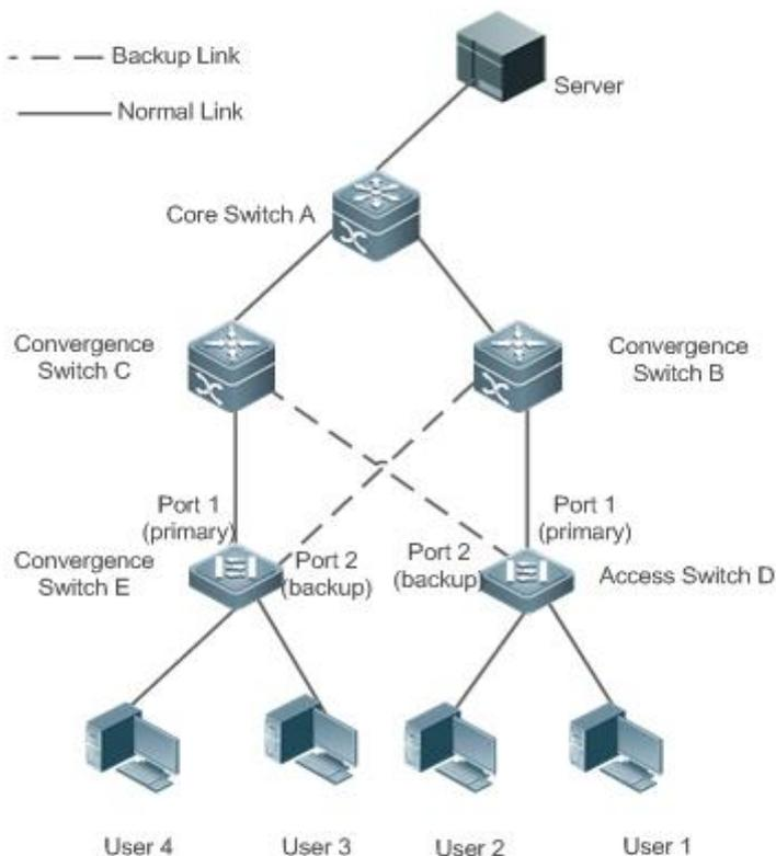
Рисунок 1-2. Топология с двумя нормальными каналами
