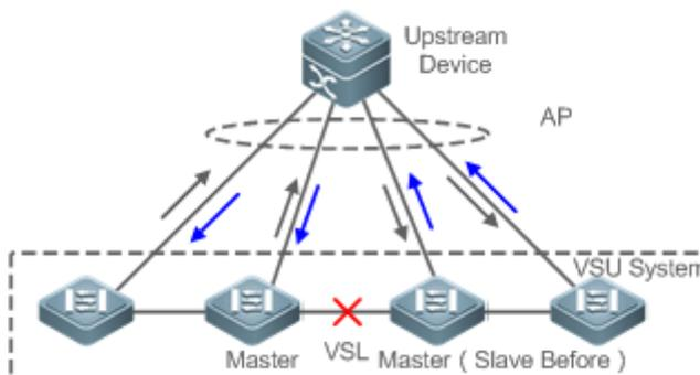
Рисунок 8-14. MAD на основе upstream- и downstream-устройств
