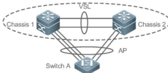
Рисунок 8-15. Порт агрегации между устройствами
