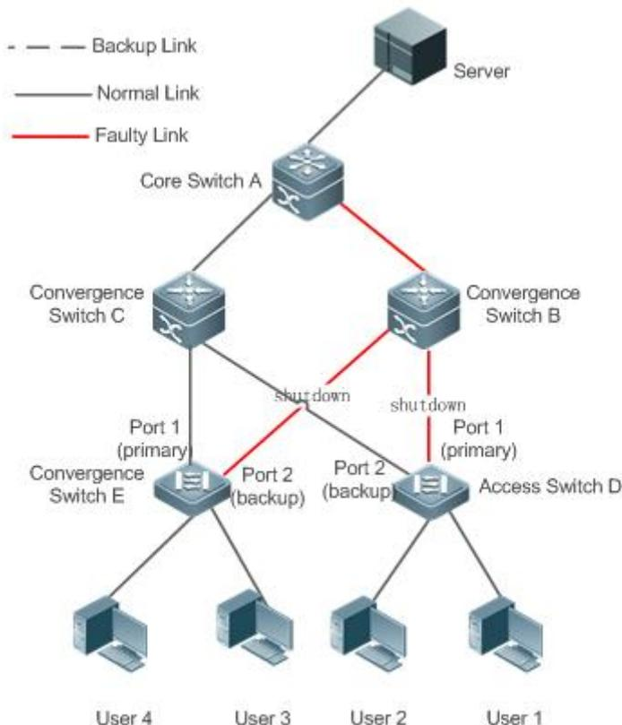
Рисунок 1-5. Топология, в которой upstream-канал активного канала неисправен
