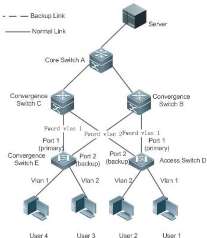
Рисунок 1-4. Топология с двумя нормальными каналами балансировки нагрузки
