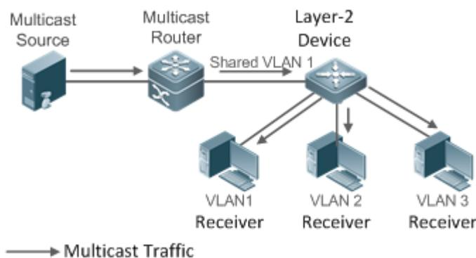
Рисунок 9-3. Сетевая топология общих сервисов multicast (multicast VLAN)
