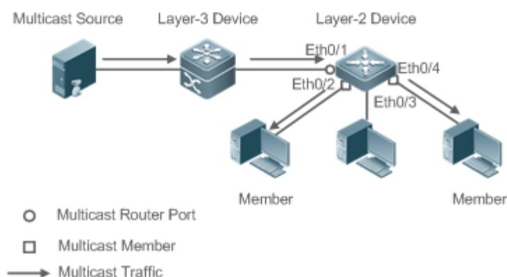
Рисунок 9-4. Сетевая топология двух портов IGMP snooping
