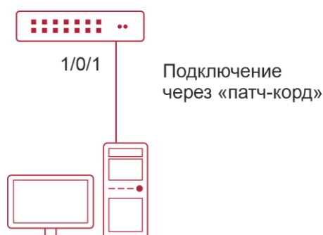
Рисунок 1-6. Управление коммутатором по Telnet
