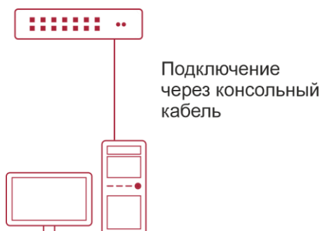
Рисунок 1-1. Подключение ПК к консольному порту коммутатора
