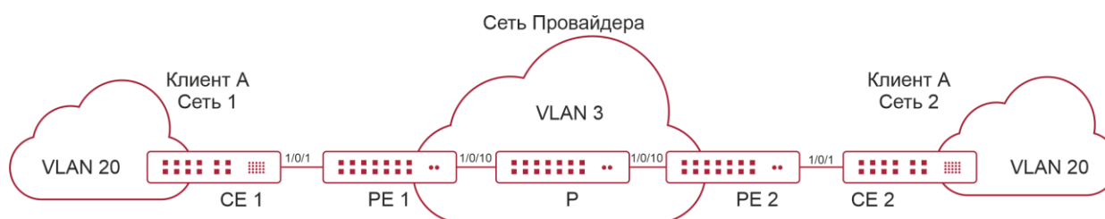
Рисунок 15-6. Топология сети с трансляцией VLAN'ов
