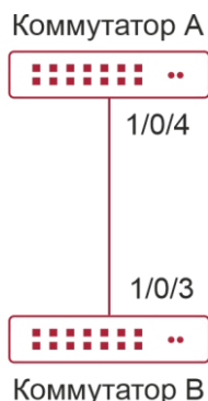
Рисунок 7-1. Типовой пример конфигурации функции LLDP
