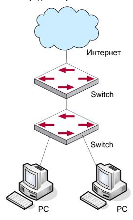
PC1 подключен к интерфейсу Ethernet 1/0/7 коммутатора B, PC2 подключен к интерфейсу Ethernet 1/0/9 коммутатора B. Порт Ethernet 1/0/10 коммутатора A к порту Ethernet 1/0/10 коммутатора B.
