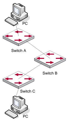
Для получения информации динамической регистрации VLAN и ее обновления на коммутаторах должен быть сконфигурирован протокол GVRP.
