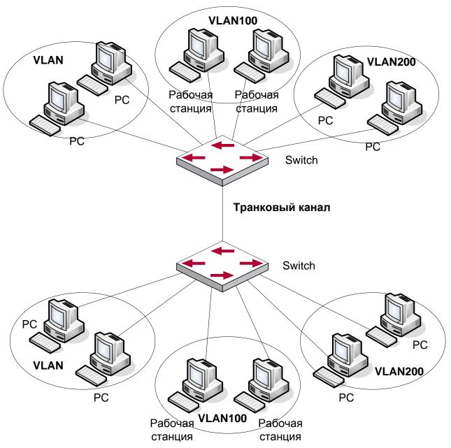
В соответствии с требованиями приложений и безопасности существующую локальную сеть необходимо разделить на три VLAN. Три VLAN имеют идентификаторы VLAN2, VLAN100 и VLAN200. Эти три VLAN охватывают два различных физических места размещения: площадки A и B.
