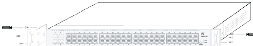
Рисунок 3-1 Монтаж кронштейнов на коммутатор
