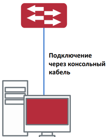
Рисунок 1. Подключение ПК к консольному порту коммутатора
