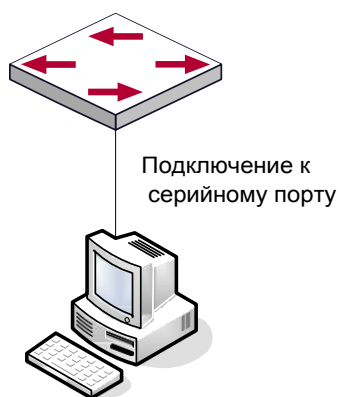
Подключение ПК к консольному порту коммутатора
