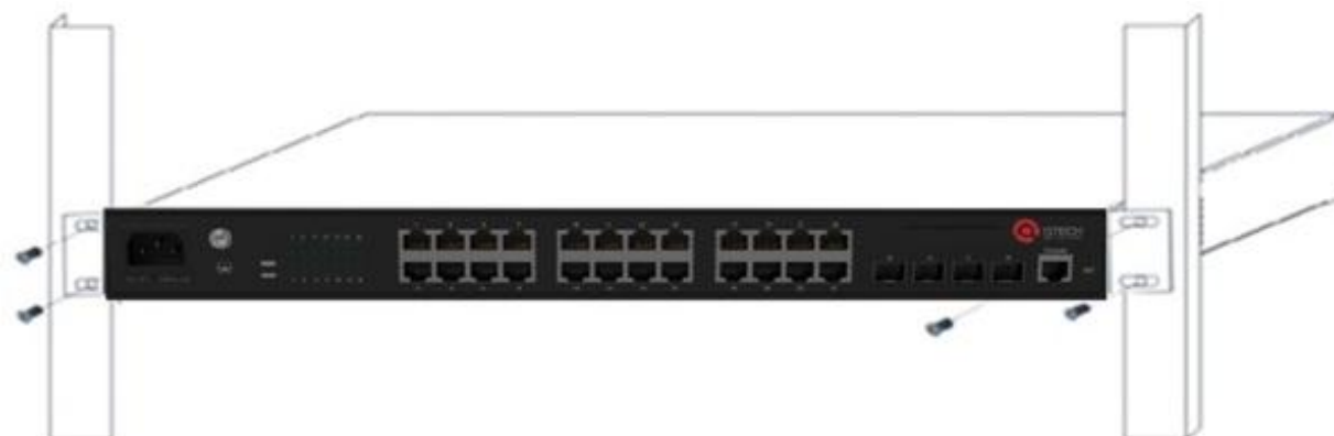
Присоединение монтажных скоб к корпусу
