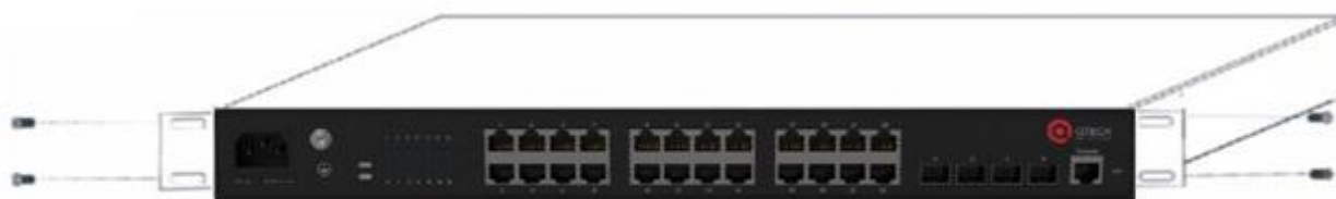
Присоединение монтажных скоб к корпусу
