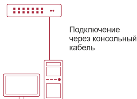
Рисунок 4-2. Подключение ПК к консольному порту коммутатора
