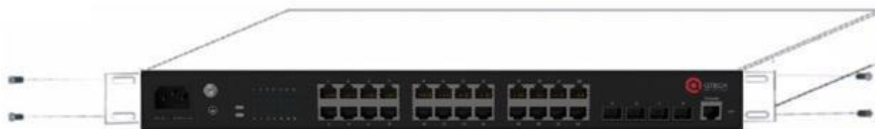
Рисунок 1. Присоединение монтажных скоб к корпусу
