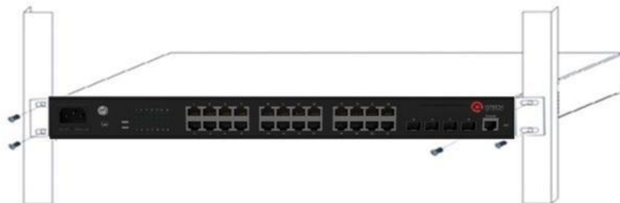
Рисунок 2. Установка коммутатора в стойку
