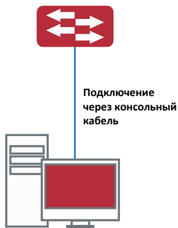
Подключение ПК к консольному порту коммутатора
