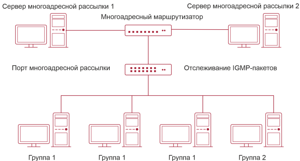
Рисунок 34-1. Включение функции отслеживания IGMP-пакетов
