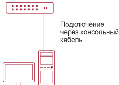
Рисунок 1-1. Подключение ПК к консольному порту коммутатора
