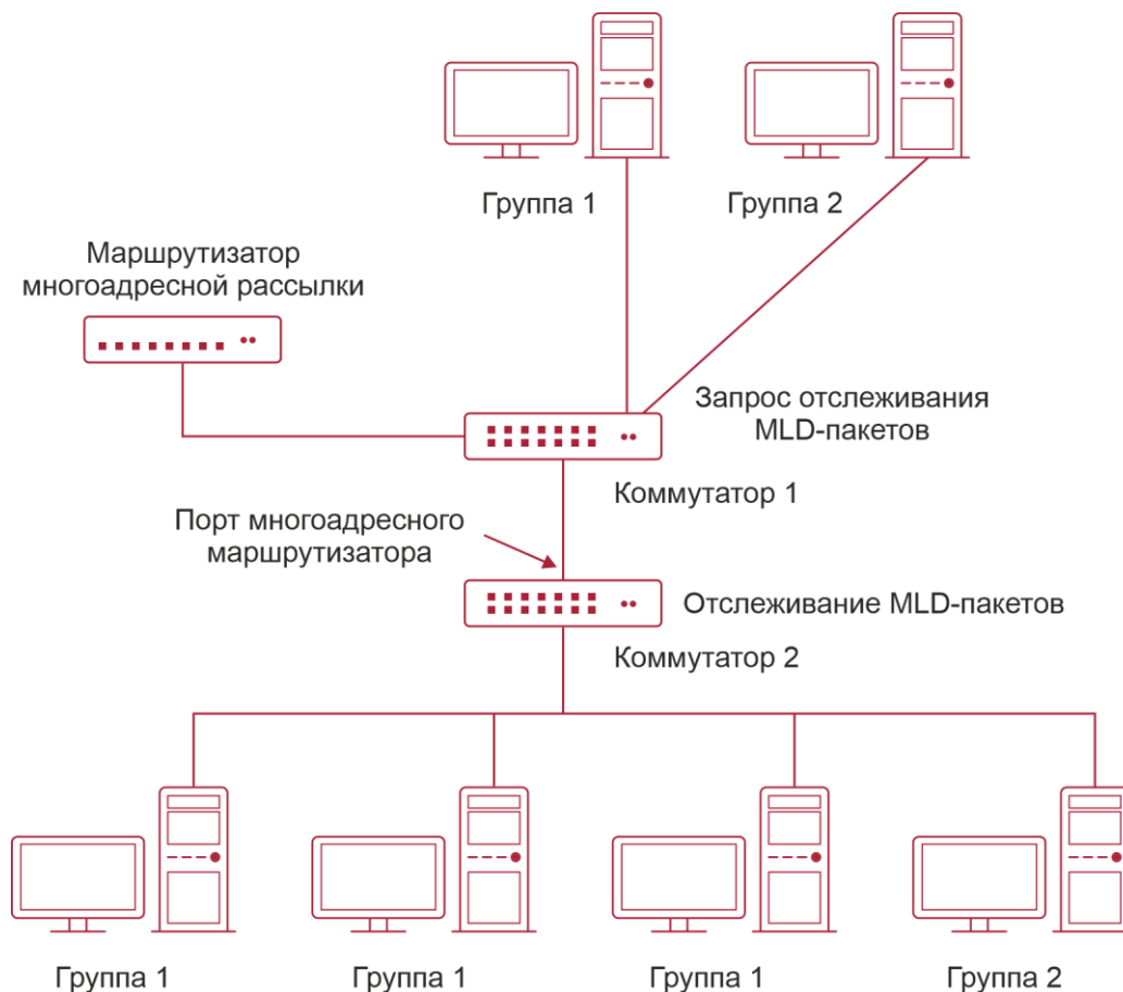
Рисунок 35-2. Коммутатор как генератор запросов при отслеживании MLD-пакетов
