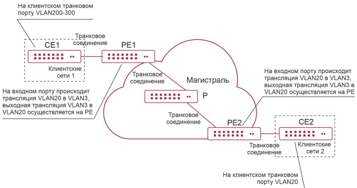
Рисунок 15-6. Топология сети с трансляцией VLAN'ов
