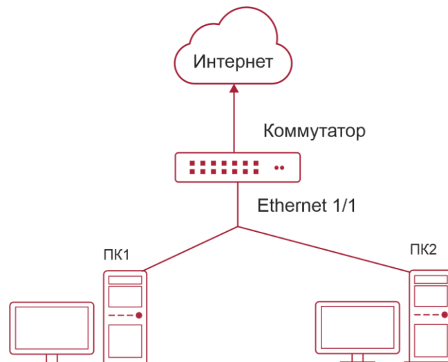
Рисунок 11-1. Типичная схема топологии для безопасности порта
