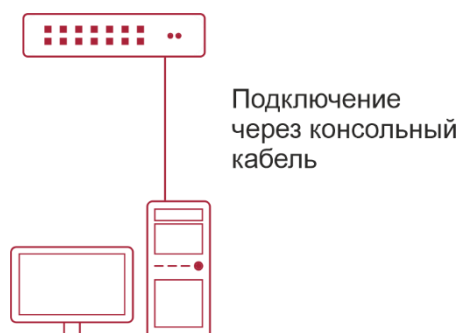
Рисунок 3-1. Подключение ПК к консольному порту коммутатора
