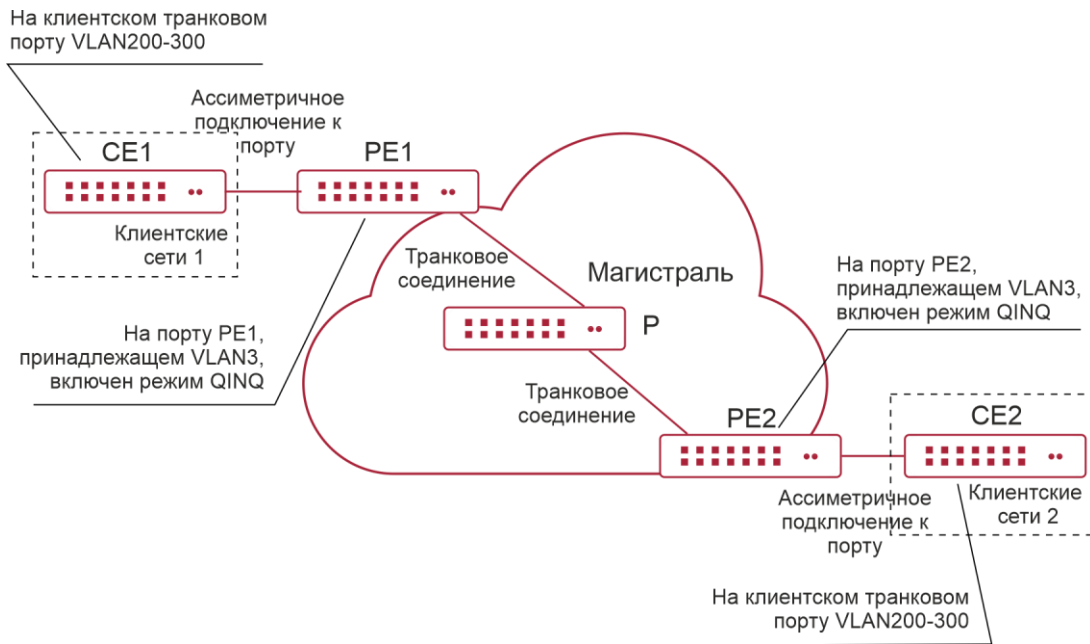
Рисунок 16-4. Межсетевое взаимодействие на основе Dot1q туннеля
