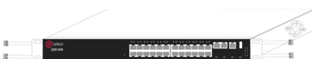
Рис. 2-1 Крепление кронштейнов к коммутатору
