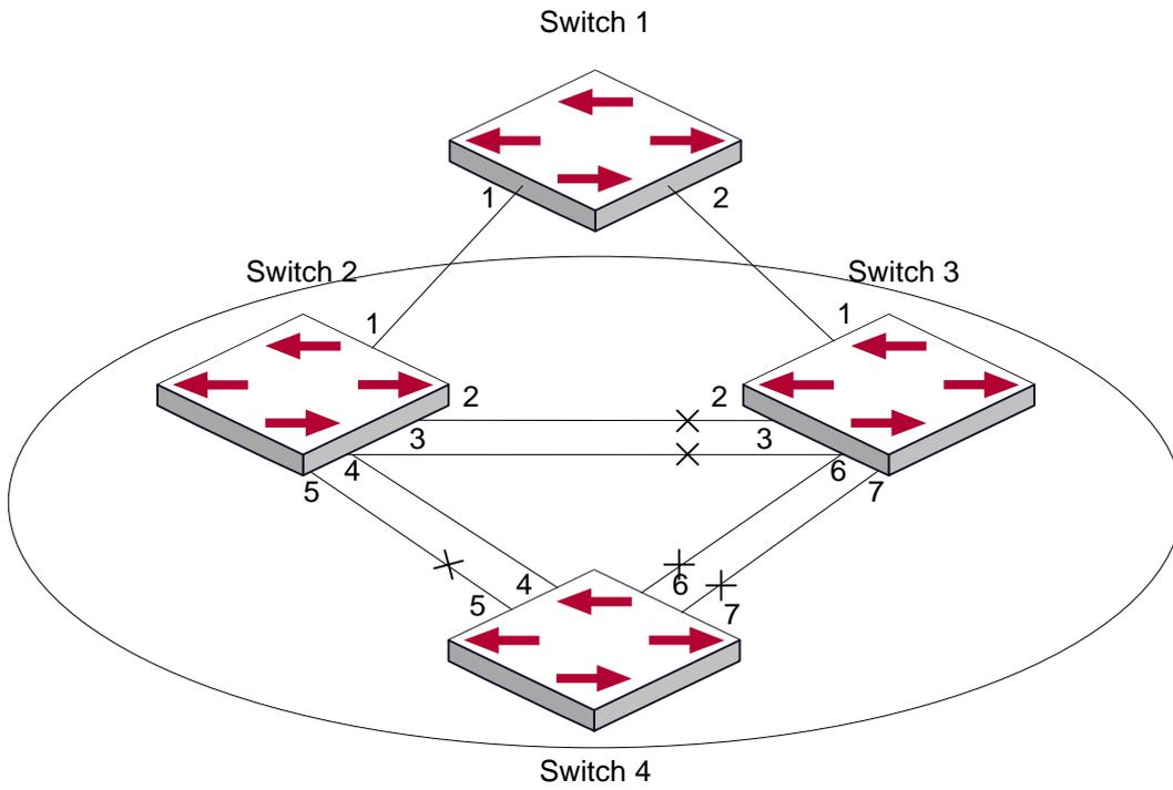
Топология экземпляра связующего дерева 0 после вычисления MSTP
