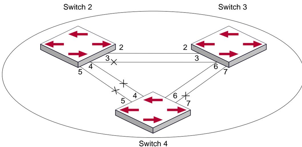
Топология экземпляра связующего дерева 3 после вычисления MSTP
