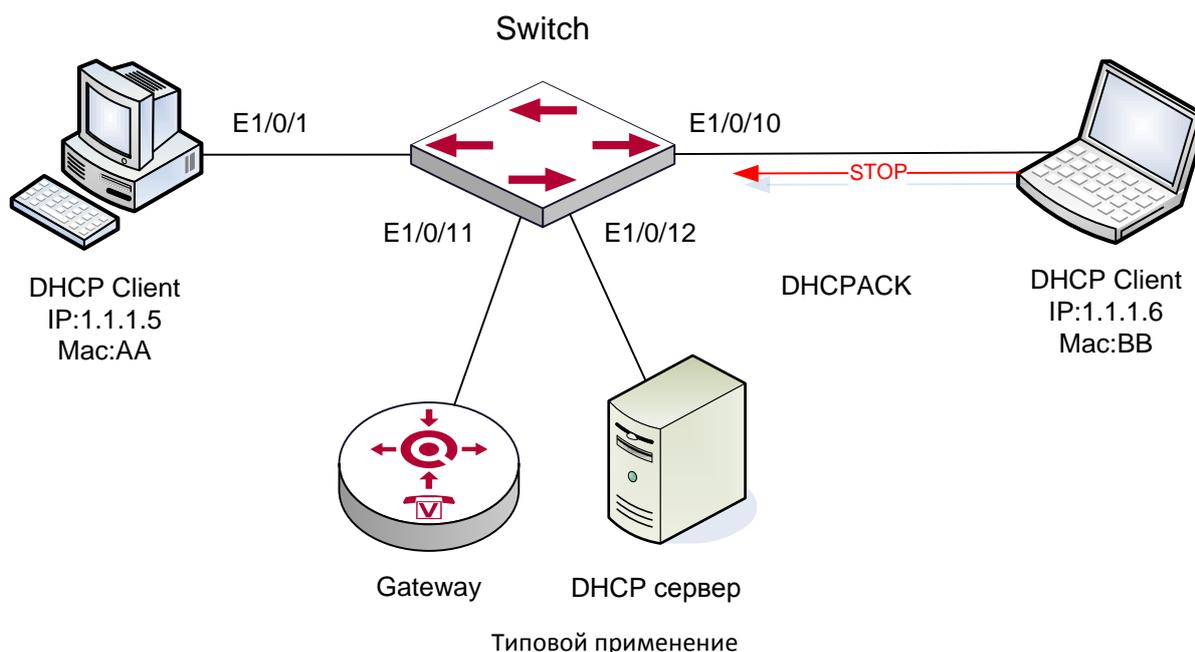
Как показано на рисунке, устройство Mac-AA – обычный пользователь, подключенный к недоверенному порту 1/1 коммутатора, получает IP настройки через DHCP, IP адрес клиента 1.1.1.5. DHCP сервер и шлюз подключены к доверенным портам коммутатора, 1/11 и 1/12 соответственно. Злоумышленник Mac-BB, подключенный к недоверенному порту 1/1 коммутатора, пытается подделать DHCP сервер (посылая пакеты DHCPACK). Функция DHCP Snooping на коммутаторе эффективно обнаружит и блокирует такой тип сетевой атаки.
