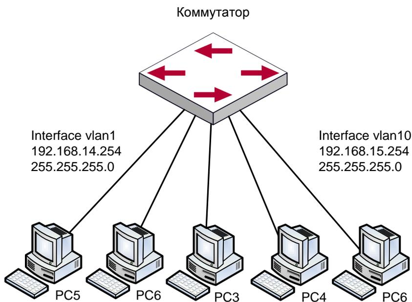
Для топологии сети, показанной на рисунке, интерфейс коммутатора VLAN10 имеет IP адрес 192.168.15.254 и маску сети 255.255.255.0. Три компьютера – PC3, PC4, PC5 – подключены к этому интерфейсу. Интерфейс VLAN1 имеет IP адрес 192.168.14.254 и маску сети 255.255.255.0. Два компьютера – PC1 и PC2 – подключены к этому интерфейсу. Самообращенный ARP включается следующей конфигурацией:
