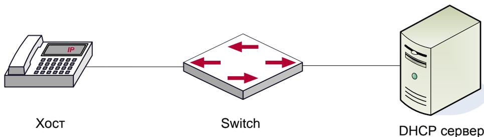
Fit AP получает IP адрес и опцию 43 – признак DHCP сервера для отправки одноадресного discovery запроса на беспроводный контроллер. DHCP сервер настраивает опцию 60 в соответствии с опцией 60 Fit AP и возвращает 43 опцию FTP AP.
