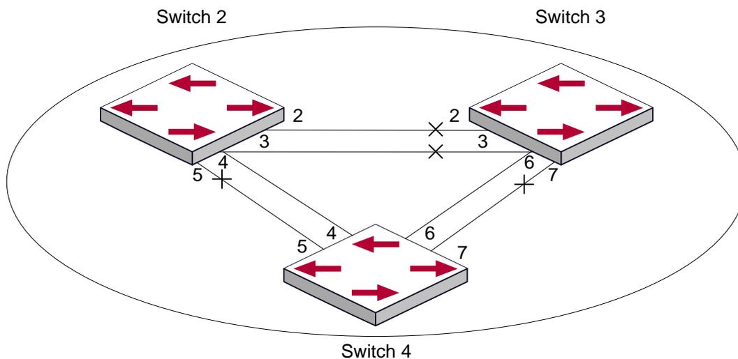
Топология экземпляра связующего дерева 4 после вычисления MSTP
