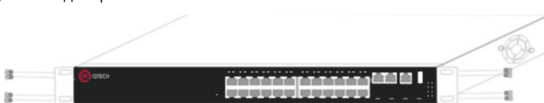
Рис. 2-1 Крепление кронштейнов к коммутатору
