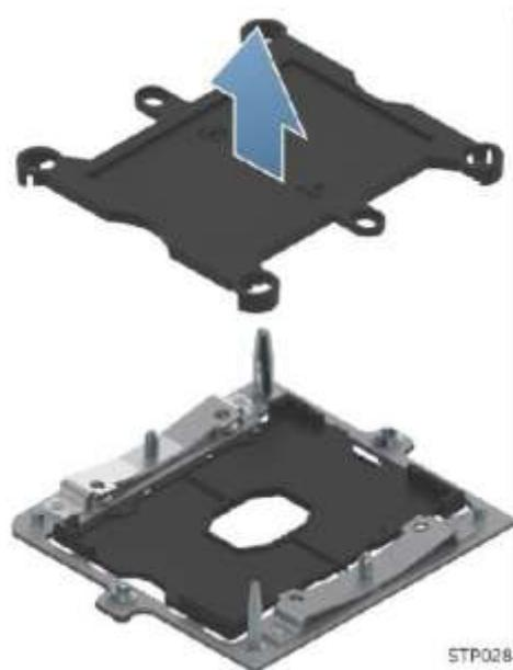
Рисунок 20. Узел процессорного гнезда и защитная крышка
