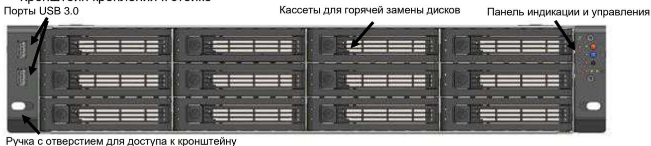
Рисунок 2. Передняя панель корпуса
