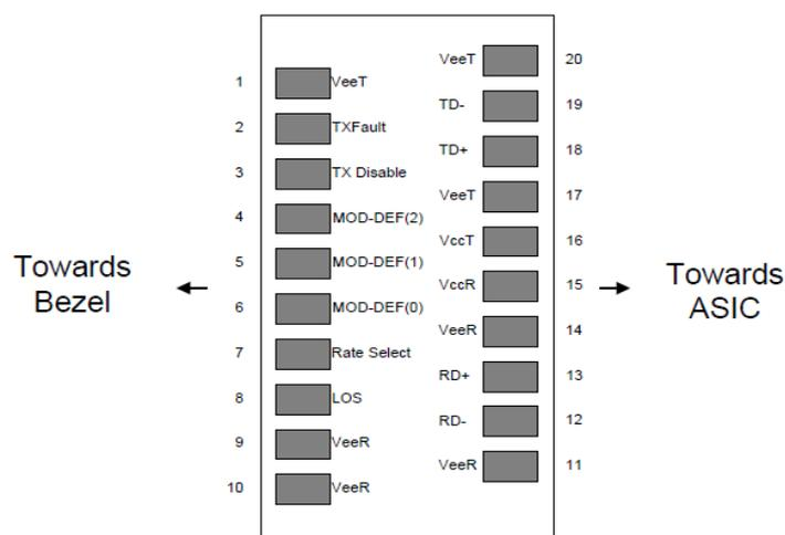
Рис. 1 Контактные разъемы на выходе блока коннектора хост-платы
