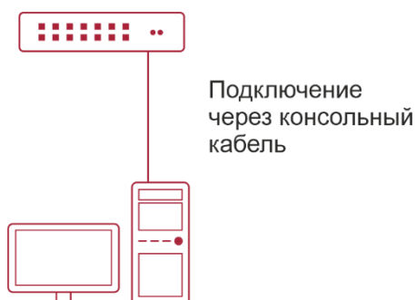
Рисунок 4-3. Подключение ПК к консольному порту коммутатора
