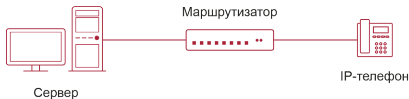
Рисунок 8-1. Топология базовой конфигурации LLDP-MED
