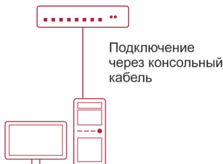
Рисунок 1-1. Подключение ПК к консольному порту маршрутизатора
