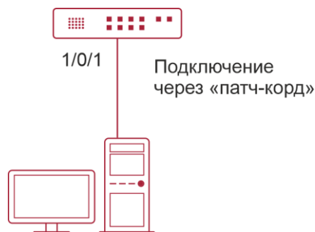
Рисунок 1-7. Управление маршрутизатором по Telnet
