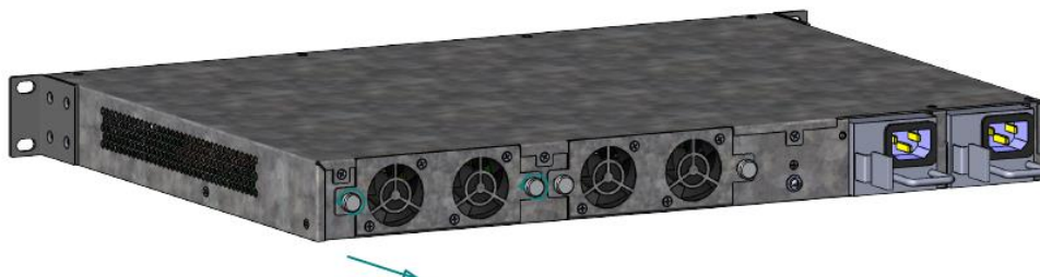
Рисунок 6-6. Снятие модуля вентиляторов QSR-M-3200-FAN
