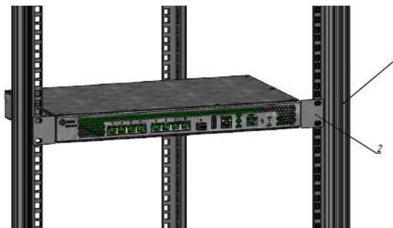
Рисунок 3-4. Установка маршрутизатора QSR-2500-9TBX-AC в стандартный шкаф
