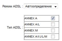
В поле «Режим ADSL» выберите режим ADSL, предоставляемый провайдером:
