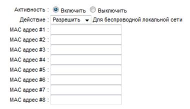
Данный блок позволяет настроить список MAC-адресов устройств, доступ в сеть которым будет либо запрещён, либо разрешён. Укажите следующие параметры:
