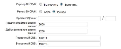
Данный блок предназначен для конфигурирования IPv6 адресов. При ручной конфигурации адресов укажите следующие параметры:
