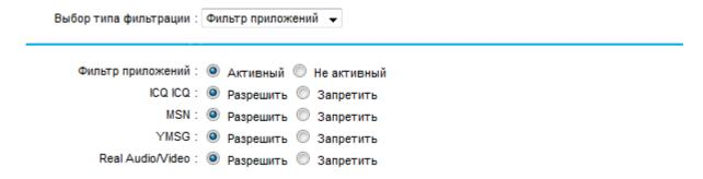
Активируйте данный вид фильтрации в поле «Выбор типа фильтрации». Используя фильтрацию по приложениям, можно разрешить или запретить доступ следующим службам:
