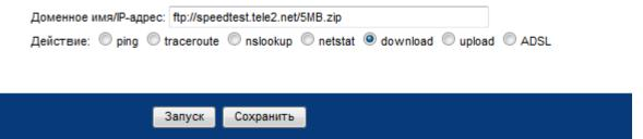
❖ upload – утилита диагностики upload позволяет оценить скорость исходящего Интернет канала посредством загрузки файла на доверенный сервер. Нажмите кнопку Запуск для начала процедуры диагностики. Нажмите кнопку «Сохранить» для записи полученных результатов диагностики в файл.
