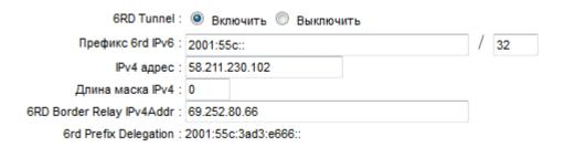
Данный пункт меню предназначен для настройки функции использования протокола IPv6 поверх сети IPv4. Выполните настройку следующих параметров:
