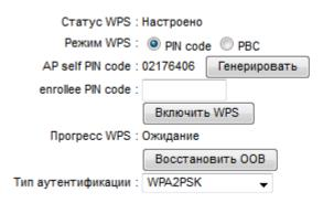
Данный блок позволяет настроить протокол WPS (Wi-Fi Protected Setup), при помощи которого можно выполнить быстрое полуавтоматическое создание домашней беспроводной сети. Укажите следующие параметры:
