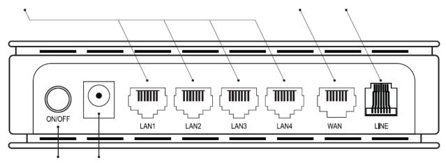
Кнопка Вкл/Выкл Разъем для подключения адаптера питания
