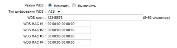
Данный блок позволяет настроить режим WDS для роутера, который позволяет расширить зону покрытия беспроводной сети при помощи объединения нескольких точек доступа Wi-Fi. Укажите следующие параметры:
