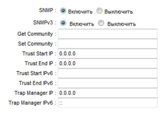
Данный пункт позволяет настроить использование протокола SNMP и его параметры. Активируйте использование протокола SNMP в поле «SNMP», а также использование протокола SNMP версии 3 в поле «SNMPv3» при необходимости. Далее настраиваются следующие параметры:
